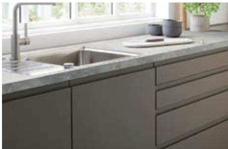
Bei dieser Front ist die Griffleiste in die Front integriert.
